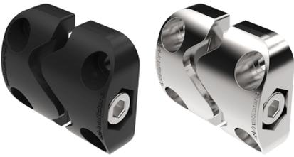
3D-Intellclamp™ zur Verbindung von Sektionen von Gehäusen oder Rahmen. Durch das Anziehen der 3D-Intellclamp™ Justierschraube richten sich die Gehäuse in X-, Y- und Z- Achse selbstständig aus. Die beiden Anlageflächen werden fest aufeinander gezogen. Montage mit Nieten oder Schrauben. Jeder 3D-Intellclamp™ besteht aus zwei ineinander greifenden Hälften, Justierschraube und Mutter.
